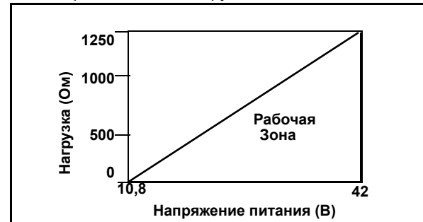
Рис. 7. Ограничения по нагрузке цепи постоянного тока
