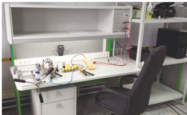
Рис. 2. Полуавтоматизированный метрологический стенд поверки, калибровки и ремонта манометров на базе калибратора давления ЭЛМЕТРО-Паскаль-02
