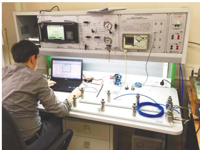
Рис. 3. Стенд поверки датчиков давления на базе контроллера WIKA CPC-6000, поставленный в ФГУП «Самарский ЦСМ»
