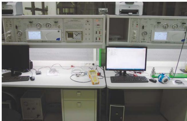
Рис. 4. Стенды поверки датчиков давления на базе контроллера DRUCK PACE6000, поставленные в ОАО «Теплоприбор», г. Челябинск
