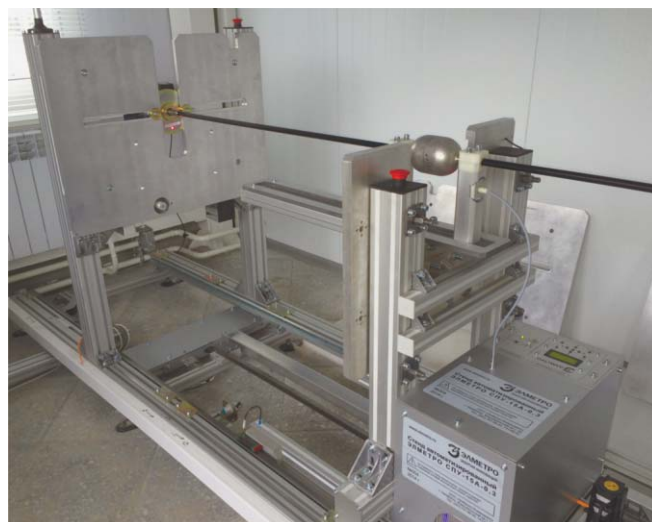
Рис. 17. Фрагмент стенда для поверки уровнемеров с установленным поплавковым уровнемером
