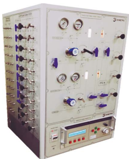
Рис. 14. Стоечное исполнение стенда поверки, калибровки и ремонта газоанализаторов
