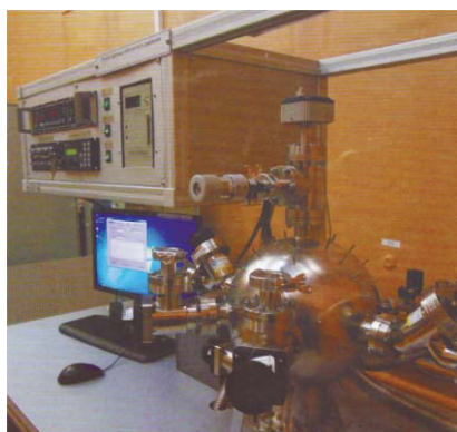
Рис. 11. Вакуумметрическая поверочная установка в ГНМЦ МО РФ.
