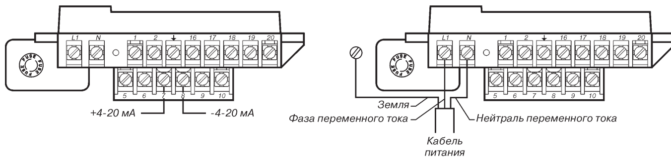
Рис.3. Схема подключения преобразователя 8712E к контуру 4-20 мА.
