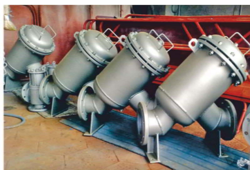
ФИЛЬТРЫ ФЖУ с давлением до 1,6 МПа для трубопроводов с Ду 150, 200, 250, 300, 350 и 400мм
