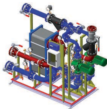
Модуль отопления Независимая схема с одним ТО и двумя насосами циркуляции отопления (для нагрузок свыше 0,5 Гкал/ч)
