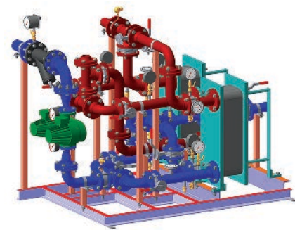
Модуль отопления Независимая схема с двумя ТО и сдвоенным насосом
