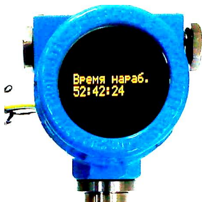
Рисунок 2 – Электронный преобразователь ЭП с цифровым индикатором
