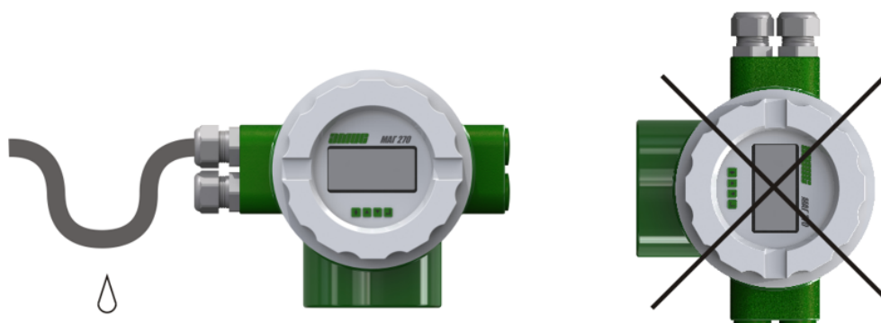
Рисунок 2.8 - Рекомендации по расположению кабелей и кабельных вводов
