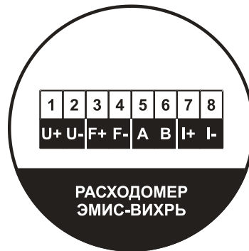
Рисунок Б.1 - Расположение зажимов клеммной колодки
