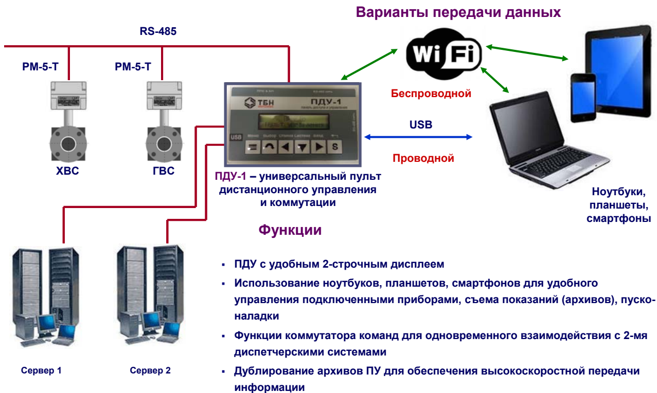
Рисунок 2 — Использование панели ПДУ-1 для управления РМ-5-Т
