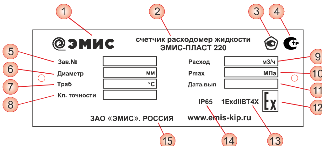
Рисунок 1.3 – Основная табличка с характеристиками прибора
