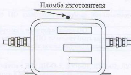
Рисунок 20 – Схема пломбировки КУП
