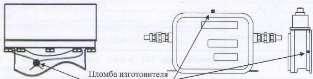
Рисунок 18 – Схема пломбировки ВП ЛУЧ-03 и ЛУЧ-04
