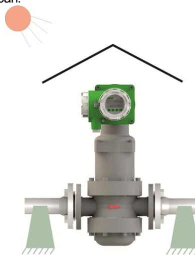
Рисунок 2.5 - Общие требования к месту установки счетчика
