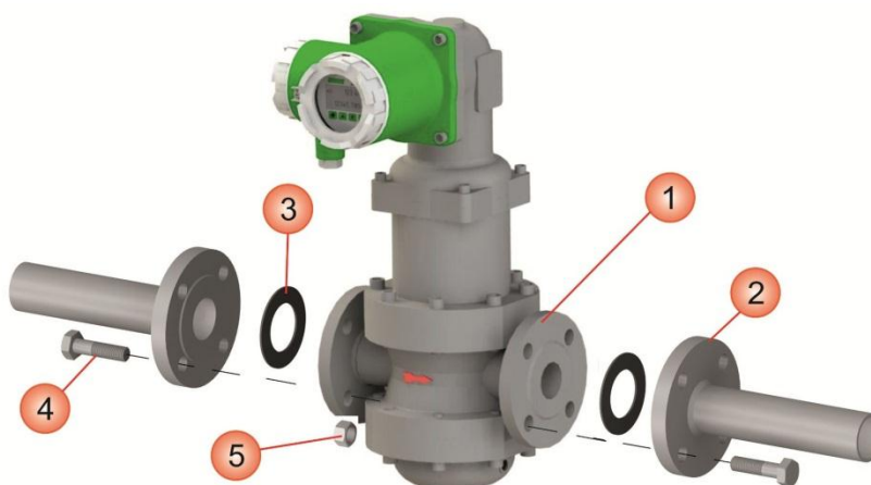
Рисунок 2.9 - Установка счетчика ЭМИС-ДИО 230 на трубопровод
