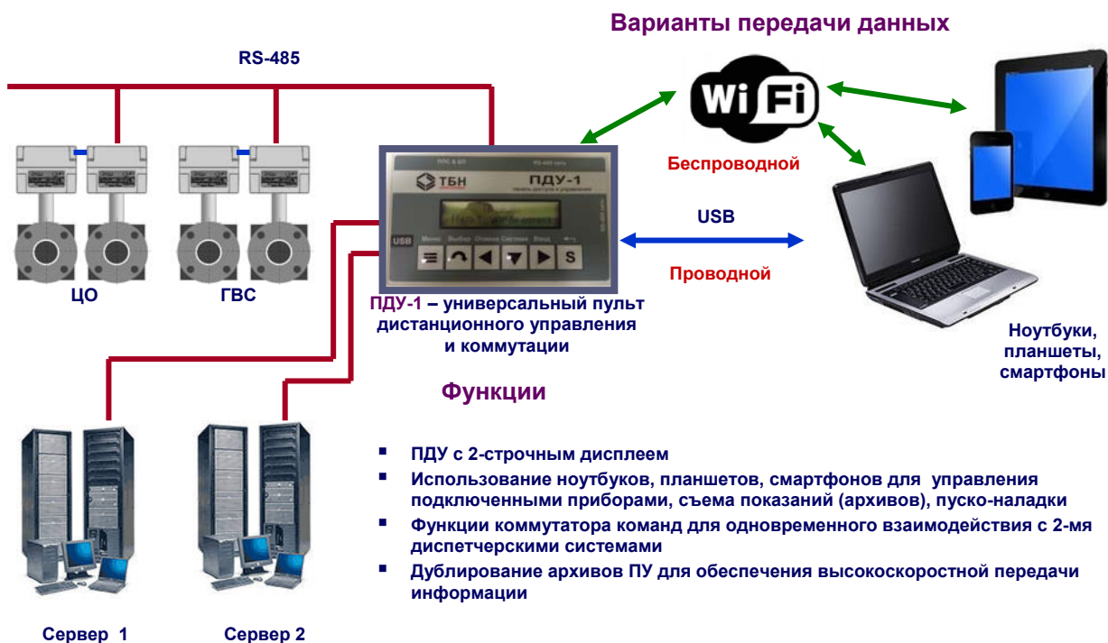
Рисунок 2 — Использование панели ПДУ-1 для управления КМ-5
